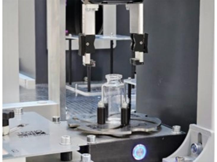
Un ulteriore plus dell'Oktilab è la sua capacità di lettura della cavità e di tenere quindi traccia del singolo Container Glass.
