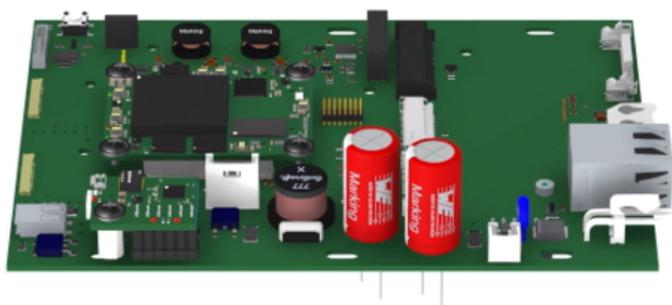
La nuova piattaforma hardware LadonBoard, progettata e sviluppata da Tecnosens, consente la gestione contemporanea di molteplici segnali video di diversa tipologia: dal flusso IP di una generica telecamera Onvif, fino allo streaming non compresso di un sensore ad altissima risoluzione.
