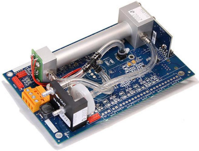
Chillcard NG è una scheda con sensore infrarosso per la rilevazione di gas refrigeranti.
