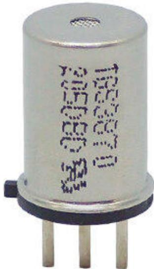
TGS 3870-F00 è un sensore di gas a semiconduttore a microsferi per il rilevamento di metano e monossido di carbonio.
