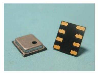
Il MIS-7300 è un sensore di pressione intelligente composto da un sensore di pressione piezoresistivo MEMS e un ASIC di condizionamento del segnale.
