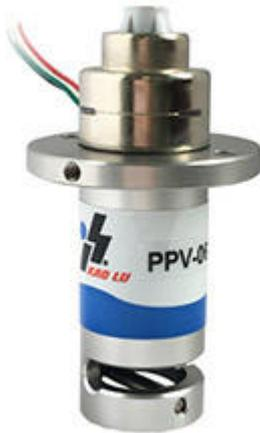
La valvola a pinza funziona in modo da aprire o chiudere un percorso del fluido in un tubo flessibile schiacciando o pizzicando il tubo. Con una valvola a pinza proporzionale, l'albero che pizzica il tubo viene quindi azionato da un motore che regola l'entità del pizzicamento, il che controlla indirettamente la portata del fluido all'interno del tubo.
