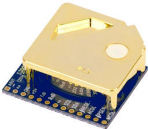
Modulo a diffusione single beam NDIR per la misura del CH4. Grazie alla sua stabilità durante il ciclo di vita e la capacità di compensare le variazioni di temperatura, è particolarmente adatto per gli ambienti industriali in cui si trasportano diversi gas infiammabili, esplosivi e in generale pericolosi.
