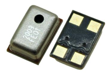
SMO09A è un microfono omnidirezionale al silicio di JL World per convertire onde di pressione sonore in segnali elettrici.
