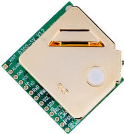
Modulo infrarosso dual beam per la misura del Butano, C4H10-D3 è uno dei moduli NDIR più compatti sul mercato adatto per l'utilizzo negli impianti di stoccaggio di gas e nelle stazioni petrolifere grazie al suo eccellente algoritmo di calibrazione, alla sua stabilità nel tempo ed alla facile manutenzione.
