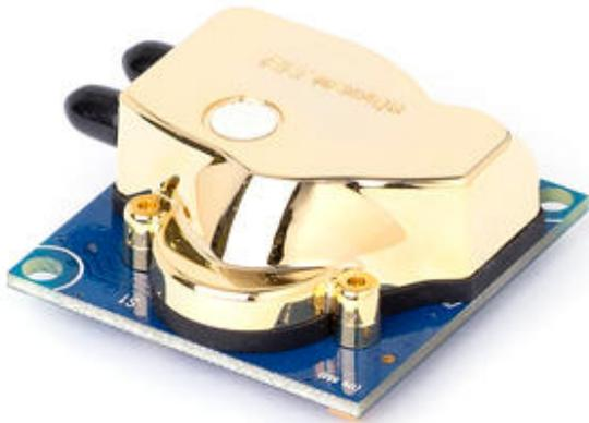
Modulo a diffusione dual beam NDIR per la misura del CH4. Grazie alla sua stabilità durante il ciclo di vita e la capacità di compensare le variazioni di temperatura, è particolarmente adatto per gli ambienti industriali in cui si trasportano diversi gas infiammabili, esplosivi e in generale pericolosi.
