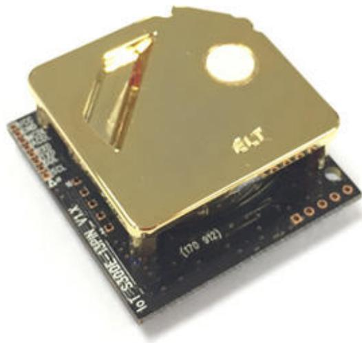
Modulo NDIR precalibrato per la misura della CO<sub>2</sub> sviluppato per dispositivi di monitoraggio dell'aria in appartamenti ed edifici.
