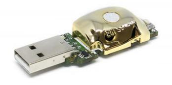
MT-200 è un modulo per CO2 NDIR compatto, precalibrato, portatile e collegabile a PC, smartphone o automobili attraverso la porta USB per controllare la qualità dell'aria in tempo reale.
