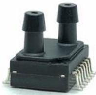
Sensore di pressione composto da elemento sensibile piezo-resistivo a base di silicio e da un circuito integrato per il condizionamento del segnale. Il segnale rilevato dal elemento sensibile viene amplificato, compensato in temperatura, calibrato ed infine convertito in un formato digitale proporzionale alla pressione campionata.
