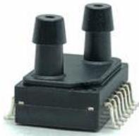
Sensore di pressione composto da elemento sensibile piezo-resistivo a base di silicio e da un circuito integrato per il condizionamento del segnale. Il segnale rilevato dal elemento sensibile viene amplificato, compensato in temperatura, calibrato ed infine convertito in un formato digitale proporzionale alla pressione campionata.
