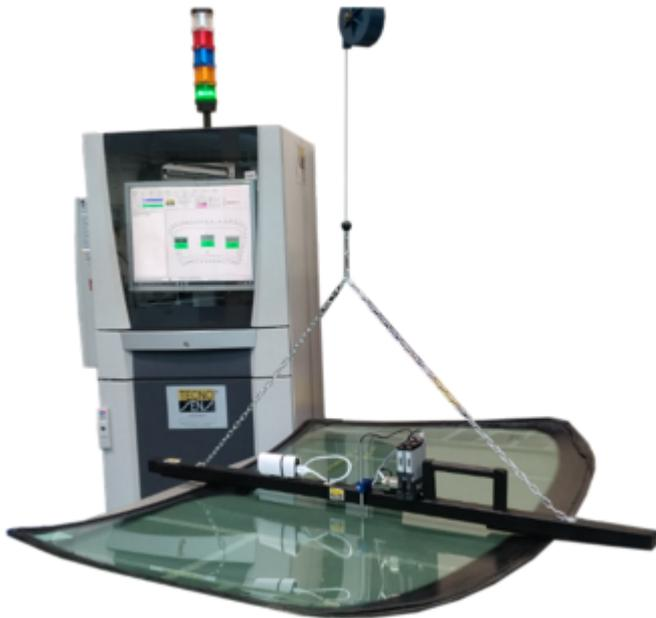
**Tecnosens Caliber WI** misura la curvatura del vetro usando la tecnologia LVDT e la **connessione wireless**. Questa soluzione è disponibile per misurazioni in-line e off-line.
