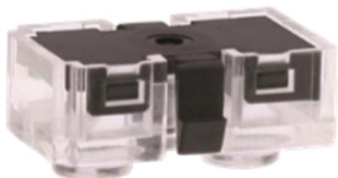
Modello KP1662 è un fotointerruttore a prisma con un LED ad infrarossi e un Photo transistor.
