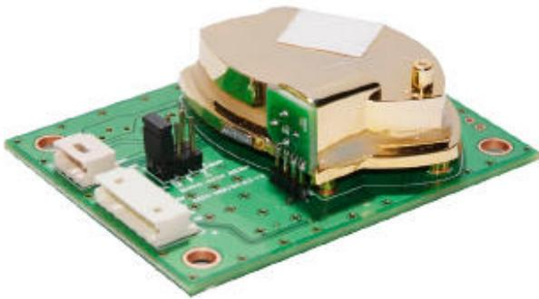
Modulo NDIR per la misura della CO<sub>2</sub>. Con un formato compatto e disponibile anche in versione Moisture proof, questo modulo è particolarmente adatto per le applicazioni in ambito agricolo.
