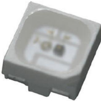
Modello KL1569 con doppia lunghezza d'onda Light Emitting Diode in SMD.
