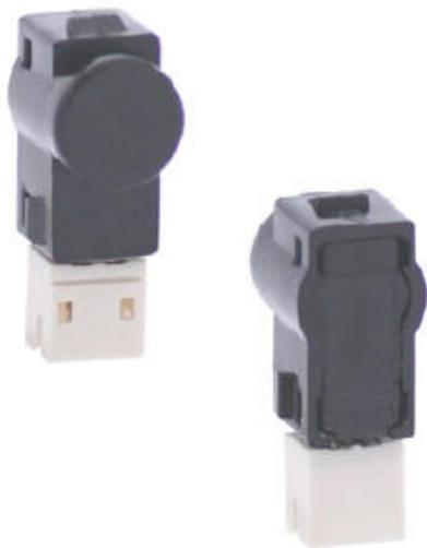
Il fotointerruttore KB3290 è costituito da un LED infrarosso e da un fototransistor.
