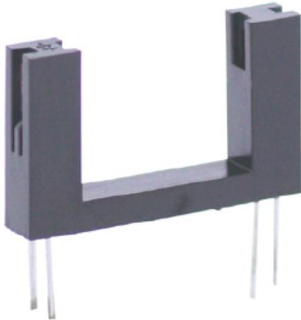
Il modello KI1223 è costituito da un led infrarosso e da un Fototransistor ad alta sensibilità con uscita analogica.
