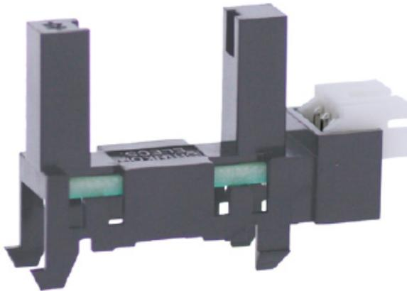
Il modello KI1220 è costituito da un led infrarosso e da un Fototransistor ad alta sensibilità.
