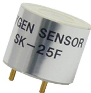
Il sensore di ossigeno SK-25F prodotto da Figaro è una cella galvanica. Le principali caratteristiche sono l'assenza di influenza da CO2 e la buona linearità fino al 30% di ossigeno.
