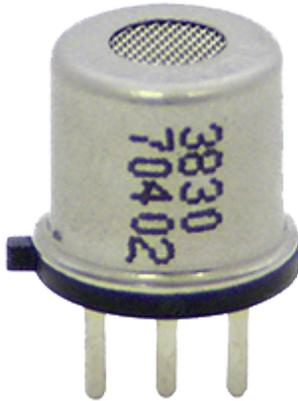
Il TGS3830 è un sensore a semiconduttore con un'alta sensibilità al gas R-134a, l'alternativa al gas R-12, comunemente usato nei sistemi di condizionamento. Grazie ai rapidi tempi di risposta, il TGS3830 è un eccellente e economico sensore per cercafughe portatili.
