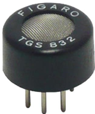
Il TGS832-A00 è un sensore a semiconduttore con un'alta sensibilità ai gas refrigeranti dei sistemi di condizionamento aria e frigoriferi come R-134a, R-404a, R-407c, e R-410. Il modello TGS832-A00 è dotato di un foro sia sul cap che nella base: utilizzando il sensore con una pompa di aspirazione, la risposta del sensore può essere accelerata, rendendolo ideale per rilevatori di fughe portatili.
