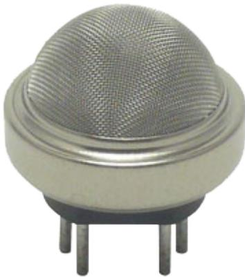
Il TGS826 è un sensore a semiconduttore con un'alta sensibilità all'ammoniaca. Il sensore può rilevare concentrazioni di 30 ppm nell'aria e è ideato per applicazioni quali rilevazione di perdite di ammoniaca nei sistemi di refrigerazione e rilevazione ammoniaca nel settore agricolo.
