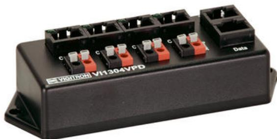
Concentratore a 4 ingressi per trasmissione Video, Dati ed Alimentazione su UTP, integra fusibili 1.5A a ripristino automatico per le linee di alimentazione, 4 ingressi per l'alimentazione delle telecamere, 4 porte RJ45 per le telecamere (video, dati, alimentazione), 2 porte RJ45 (1 per il video ed 1 per i dati) per la sala operativa
