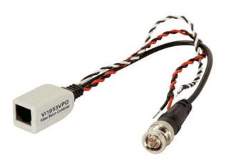
Ricetrasmettitore passivo per video, dati ed alimentazione su doppino intrecciato, connettore BNC maschio, connettore RJ45, protezione integrata dalle sovratensioni, distanza massima 330m (250m se collegato a DVR) con ricevitore passivo, 1000m con ricevitore attivo.
