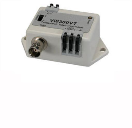
Trasmettitore attivo per video su doppino intrecciato, connettore BNC femmina, protezione integrata dalle sovratensioni, isolamento galvanico del segnale video (elimina il loop di terra), specifico per lo standard PAL, distanza massima 1200m con ricevitore attivo Vi6200, 2000m con ricevitori attivi serie Vi6300. Alimentazione 12Vdc-24Vac. Alimentatore non incluso.
