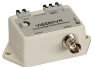
Ricevitore attivo per video su doppino intrecciato, uscita BNC, protezione integrata dalle sovratensioni, isolamento galvanico del segnale video (elimina i loop di terra per differenze sulle terre inferiori a 5V), equalizzatore video integrato con controllo automatico del guadagno (AGC - non richiede impostazione manuale), specifico per lo standard PAL, distanza massima con trasmettitore passivo 600 metri, 1200m con trasmettitore Vi6300VT. Alimentazione 12Vdc-24Vac. Alimentatore non incluso.
