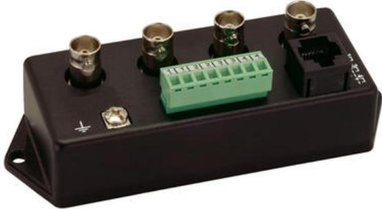
Ricetrasmittitore passivo per video su doppino intrecciato a 4 ingressi , connettore BNC femmina, protezione integrata dalle sovratensioni, distanza massima 330m (250m se collegato a DVR) con ricevitore passivo, 1000m con ricevitore attivo.
