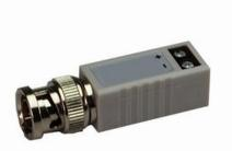
Ricetrasmettitore passivo per video su doppino intrecciato, connettore BNC maschio, protezione integrata dalle sovratensioni di modo comune e differenziale, distanza massima 330m (250m se collegato a DVR) con ricevitore passivo, 1000m con ricevitore attivo (cavo UTP Cat.5).
